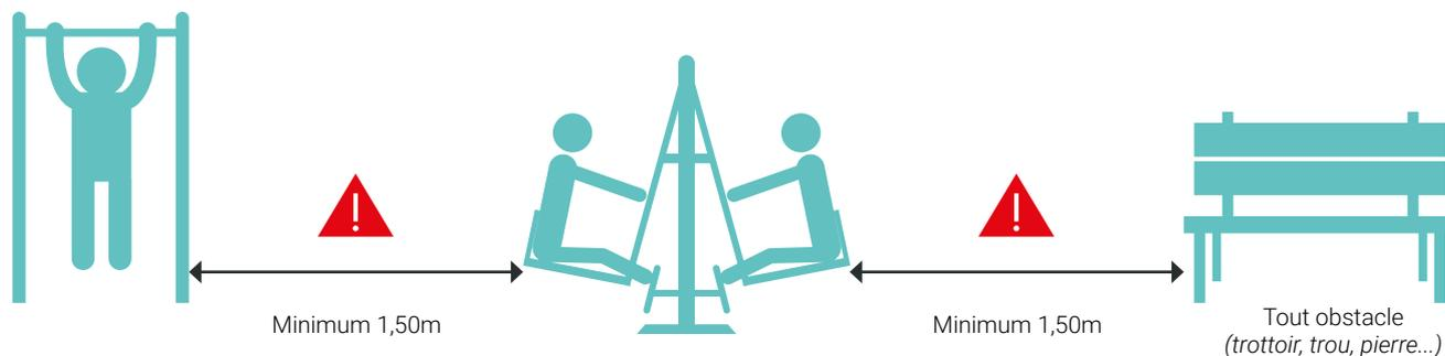
Espace minimum requis entre chaque appareil et/ou obstacle selon norme EN 16630. Attention, prenez en compte l'amplitude maximale avec l'appareil déployé pour mesurer votre surface libre.
