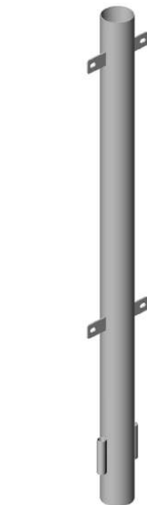
Étape 2 : Soudure continue des pattes avant traitement de l'ensemble par galvanisation à chaud.
