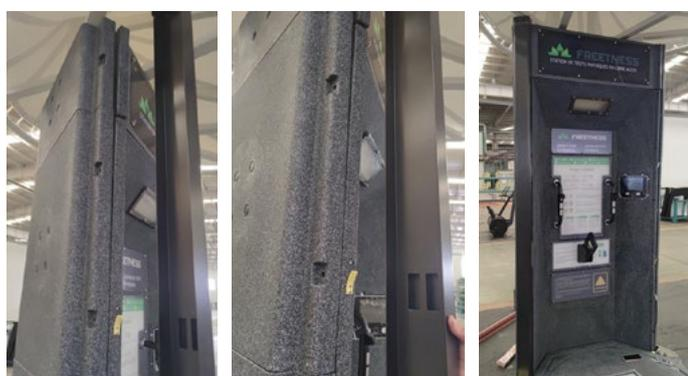
Utilisez « Capuchon antivol - Vis hexagonale intérieure à tête ronde plate M8x40 - Rondelle plate Ø8 - Capuchon antivol » pour fixer les angles de jonction 2.4 sur la plateforme 2.1.
