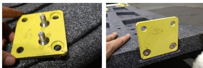
Utilisez « Vis à filetage complet à tête fraisée à six pans creux intérieur M10×20 » pour fixer les ailettes fixes 2.2 des deux côtés du corps principal 1.1.
