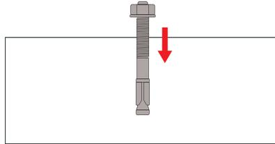
Retirer l'écrou et la rondelle. Placer la platine de l'appareil et serrer suffisamment l'écrou.
