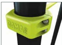
Pour la fixation des bagues sur les poteaux, on assemble la moitié de la bague (côté barre) puis on referme sur le poteau par la seconde moitié. Bien veiller à serrer les vis de manière progressive pour que les bagues soient correctement fixées. Montez la structure au fur et à mesure dans les trous de fondation. Calez la structure avec des étais afin qu'elle soit d'aplomb et qu'elle ne bouge pas le temps de séchage. Une fois le béton coulé dans les trous, pensez à barriérer la zone.
