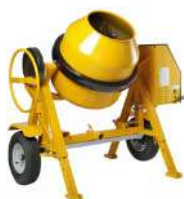
Bétonnière ou toupie Dosage béton : 350kg/m 3
